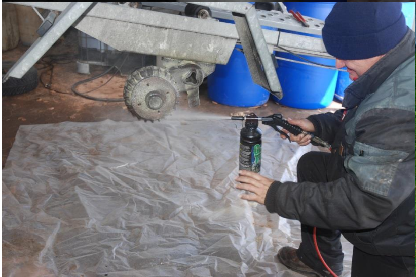
Trailer blev behandlet med Prolan Heavy 270 og sidste billede er taget 3 år efter
